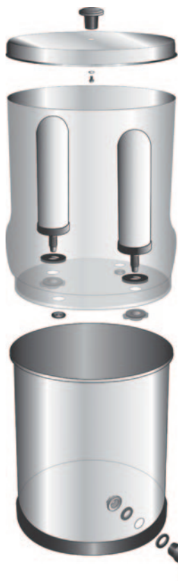
Časť 2. a 3. Montáž keramického a filtračného puzdra
